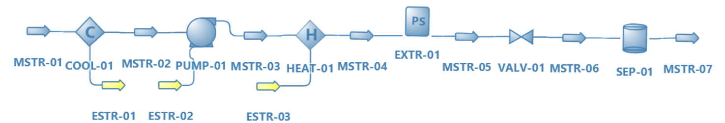
Rys.1. Schemat instalacji do ekstrakcji nadkrytycznej w programie DWSIM
