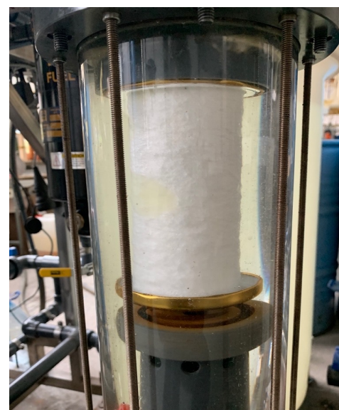
Rysunek 2. Fotografia szklanej obudowy z zamocowanym elementem koalescencyjnym.
