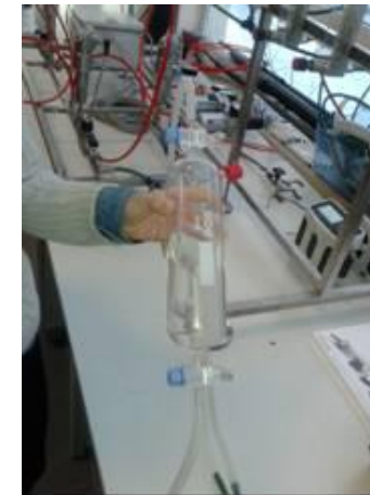
Rys.1. Napełnianie pipety szklanej gazową próbką
