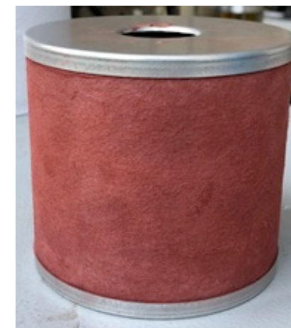
Rys.1. Zdjęcie elementu pokrytego cząstkami tlenku żelaza
