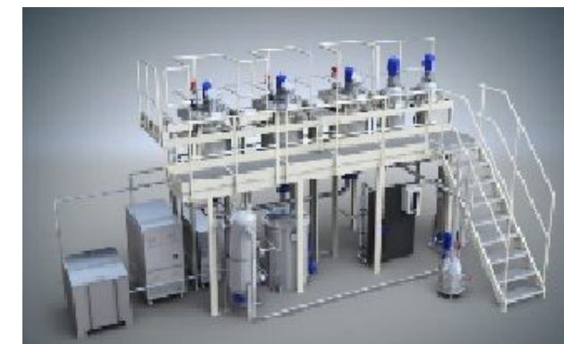
Rys.1. Schemat instalacji do produkcji bioetanolu z biomasy lignocelulozowej w Centrum Badań Energii Odnawialnej UWM
