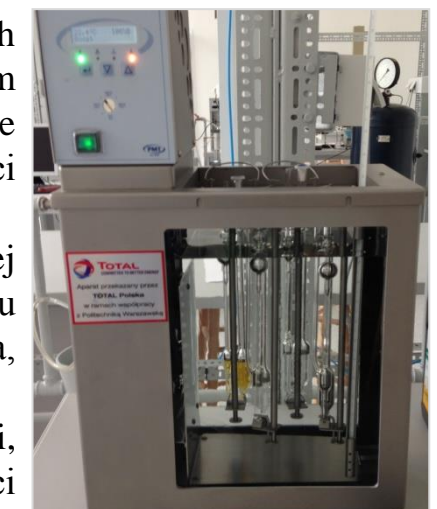
Rys 2. Układ viskozometrów Ubbelohde'a w łaźni termostatującej
