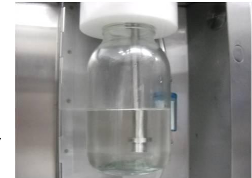
zdjęcie 1 Dysza Laskina w zbiorniku generatora
