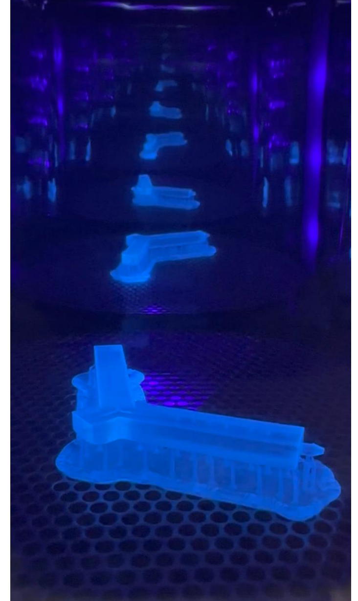
Wydruk 3D reaktora do syntezy nanocząstek
